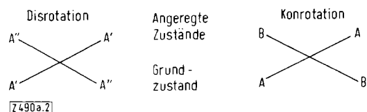
Abb. 2. Zustandskorrelationsdiagramm für die disrotatorische und für die konrotatorische elektrocyclische Radikalreaktion unter Erhaltung der Orbitalsymmetrie (in allgemeiner Form).
